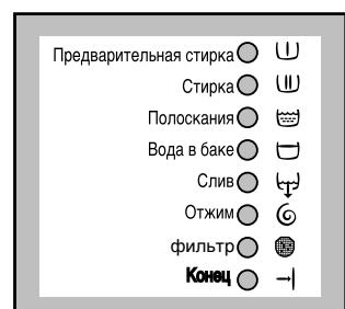
Лампа конца цикла → мигает, если возникает неисправность стиральной машины. Одновременно с этим мигает одна из следующих ламп, а код ошибки на универсальном дисплее показывает тип ошибки.
